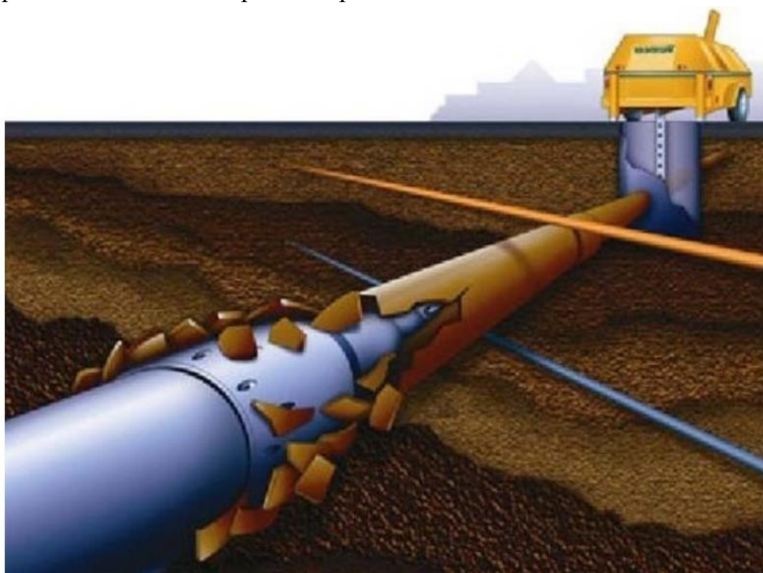
Замена трубопровода методом гидравлического разрушения
