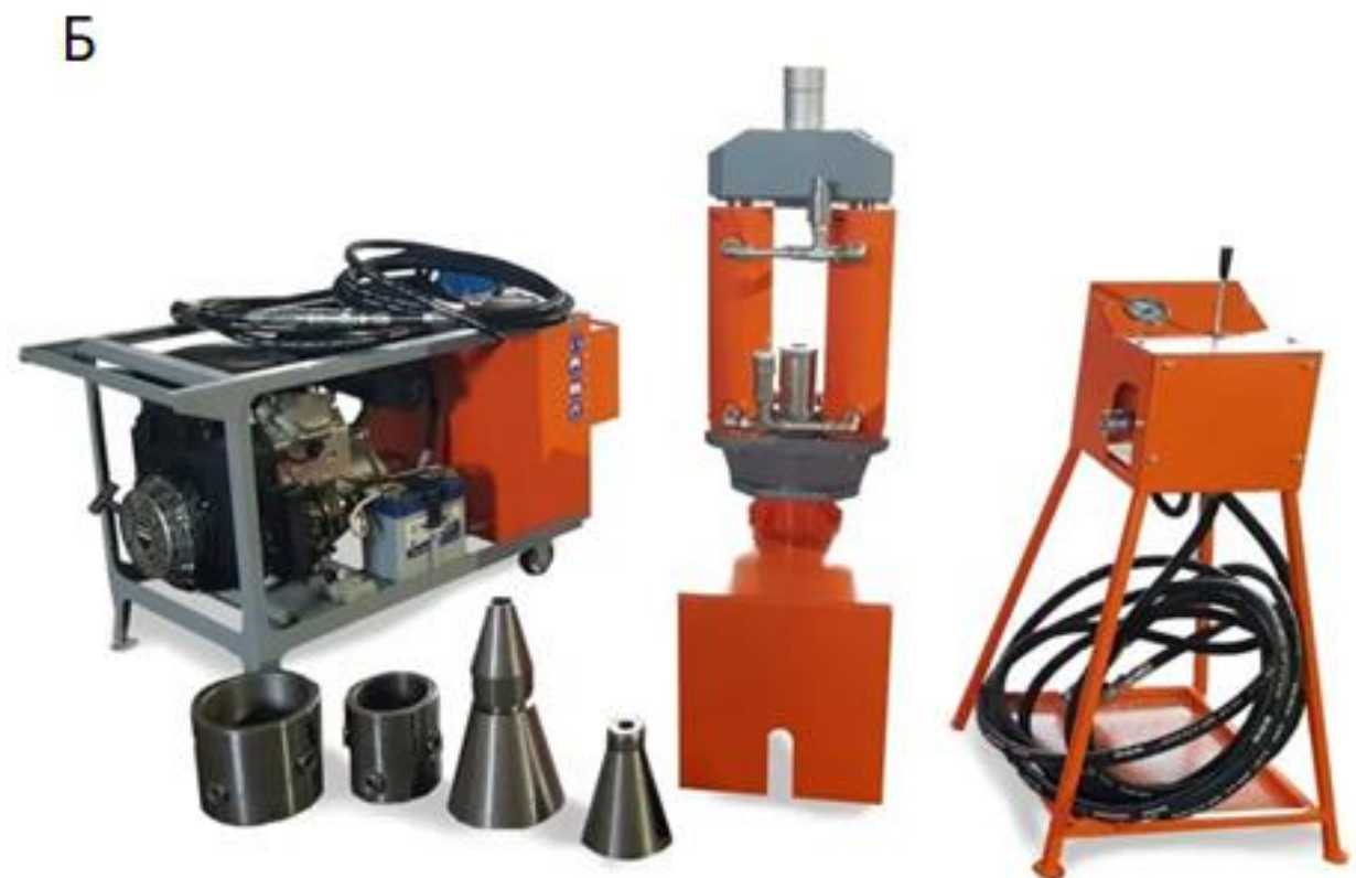
Рисунок 10. Гидравлическая установка-разрушитель. А) в рабочем состоянии, Б) в разобранном состоянии.
